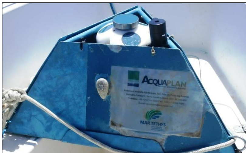
Figura 5. Equipamento AWAC® utilizado no fundeio já fixado em estrutura piramidal.
